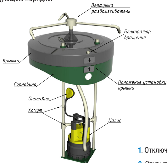
Рисунок 15. Установка циркуляционного насоса Станции
