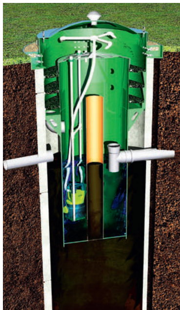
Рисунок 3. Схема работы Системы Alta Bio Lite
